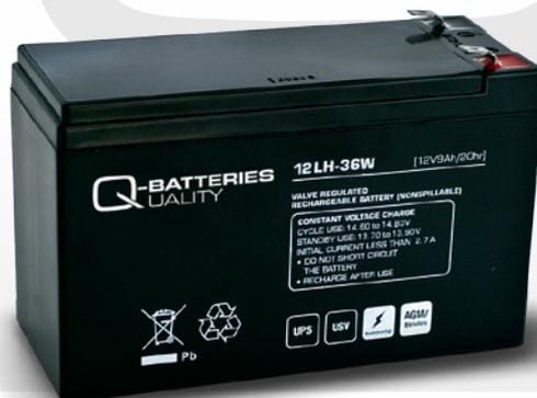
Bei dem Q-Batteries Akku 12LH-36W handelt es sich um einen AGM Akku (Blei/Vlies) der speziell für Hochstromanwendungen konzipiert wurde. Aufgrund der größeren Oberfläche der Bleiplatten, kann kurzfristig ein sehr hoher Strom beispielsweise für USV-Anlagen bereitgestellt werden.
